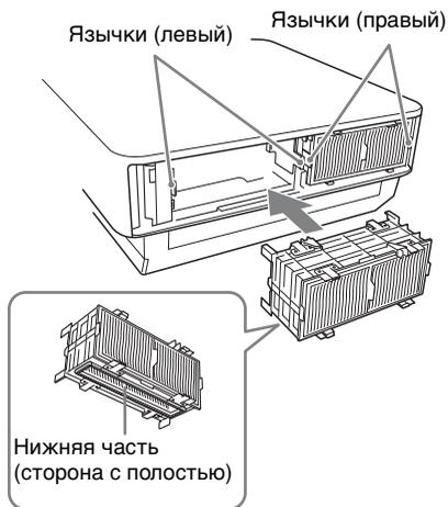
Вставьте блок воздушного фильтра на место так, чтобы язычки на проекторе зафиксировались со щелчком (в 2 точках для каждого блока воздушного фильтра, всего 4 точки).
