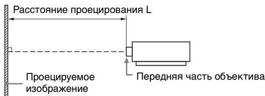
Диапазон сдвига объектива соответствует расстоянию в процентах (%), на которое можно сместить объектив от центра проецируемого изображения. Диапазон сдвига объектива принимается равным 0%, если точка на рисунке (A) (точка пересечения линии, проведенной от центра объектива и проецируемого изображения под прямым углом) выровнена с центральной частью проецируемого изображения и полная ширина, а также полная высота проецируемого изображения принимаются равными 100%.
