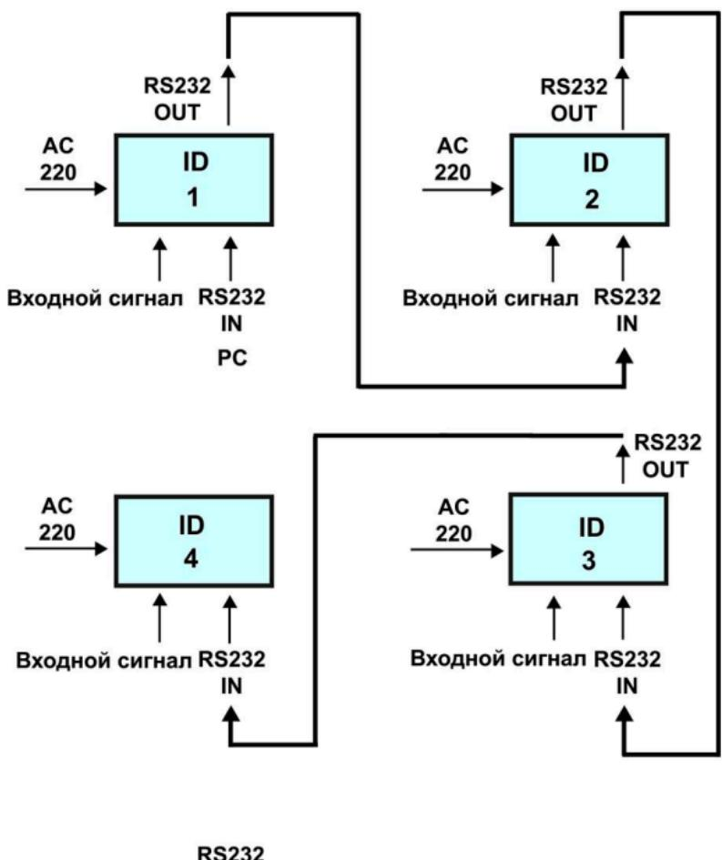
*Блок-схема видеостены (2 x 2)*
