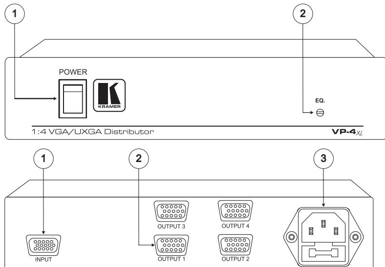
Рис. 2. Усилитель-распределитель VP-4xI
