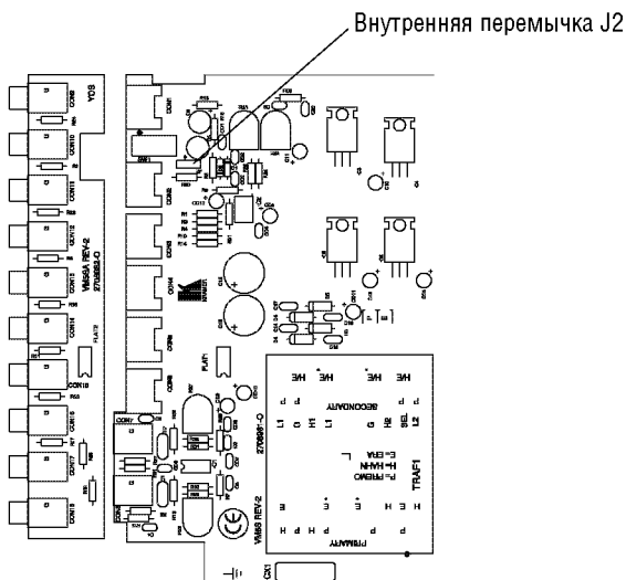
Рис. 7. Расположение внутренней перемычки J2
