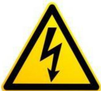
Значок молнии со стрелкой на наконечнике в равностороннем треугольнике предназначен для информирования пользователя о неизолированном «опасном напряжении» внутри корпуса устройства, силы которого достаточно для поражения пользователя электрическим током.
