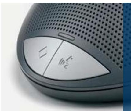
Система CCS 900 Ultro позволяет председателю контролировать и записывать ход заседания. Пульт председателя имеет приоритетную кнопку со звуковым сигналом для отключения звука микрофонов всех участников. Можно также подключать дополнительные микрофоны и другое оборудование.
