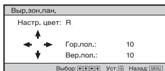
Установите уровень с помощью кнопок ←/→ для горизонтального направления (направление H) и с помощью кнопок ↑/↓ для вертикального направления (направление V). Можно снова выбрать положение для регулировки нажатием Ⓢ.
