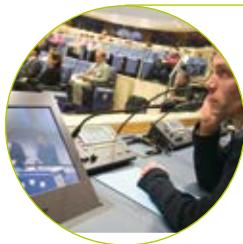
Televic Confidea® является самой многофункциональной системой. Помимо базовых функций обсуждения, она снабжена функцией синхронного перевода, присутствующей как на проводных, так и на беспроводных моделях. Беспроводные пульты поддерживают до 40 языковых каналов, проводные – до 58 каналов.
