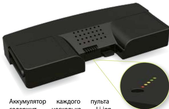
Аккумулятор каждого пульта содержит несколько Li-ion модулей, которые обеспечивают длительное время работы без потери емкости во время перезарядки.
